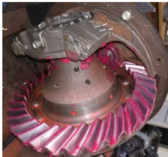
Зубчатые пары после испытаний
