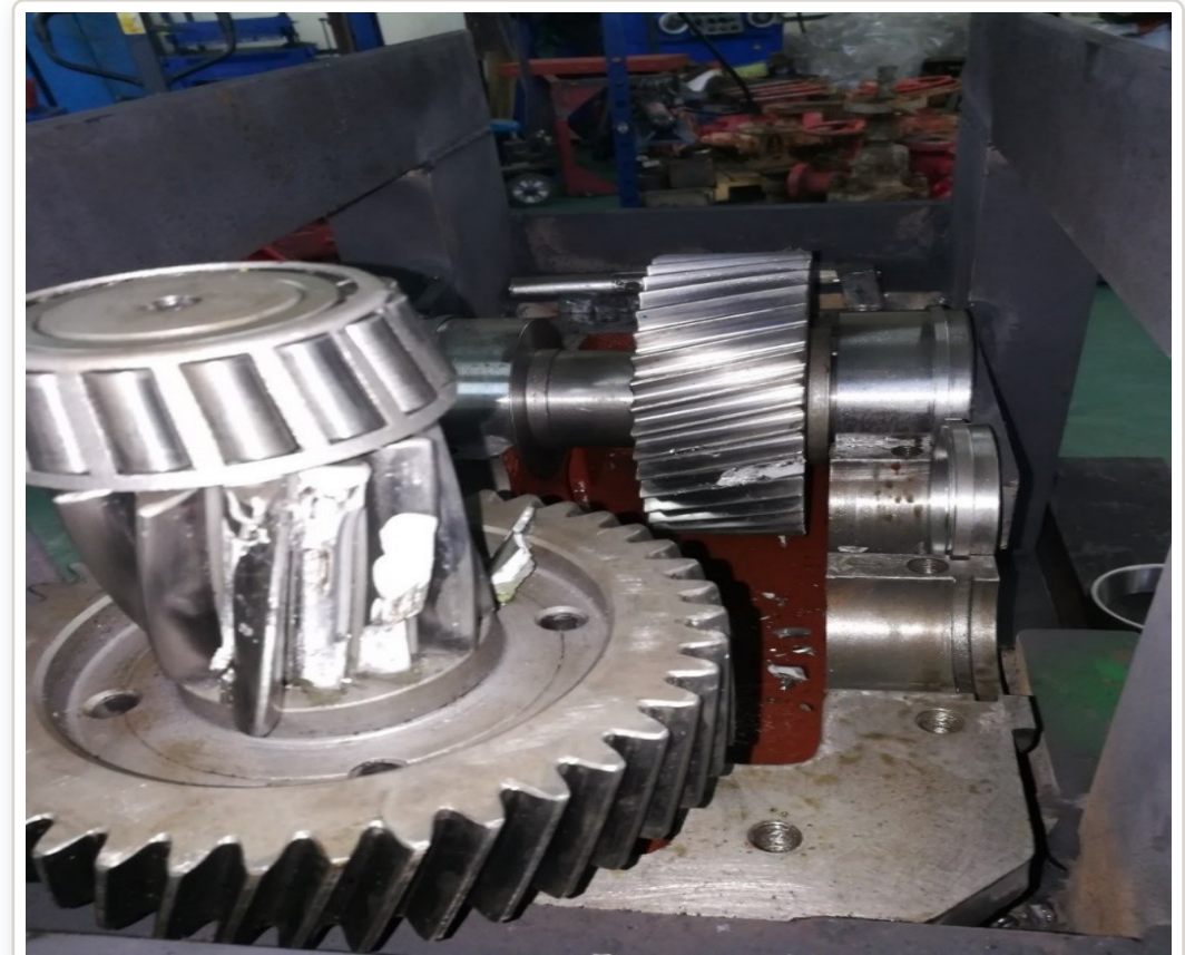
Редукторы после испытаний на предельный момент
