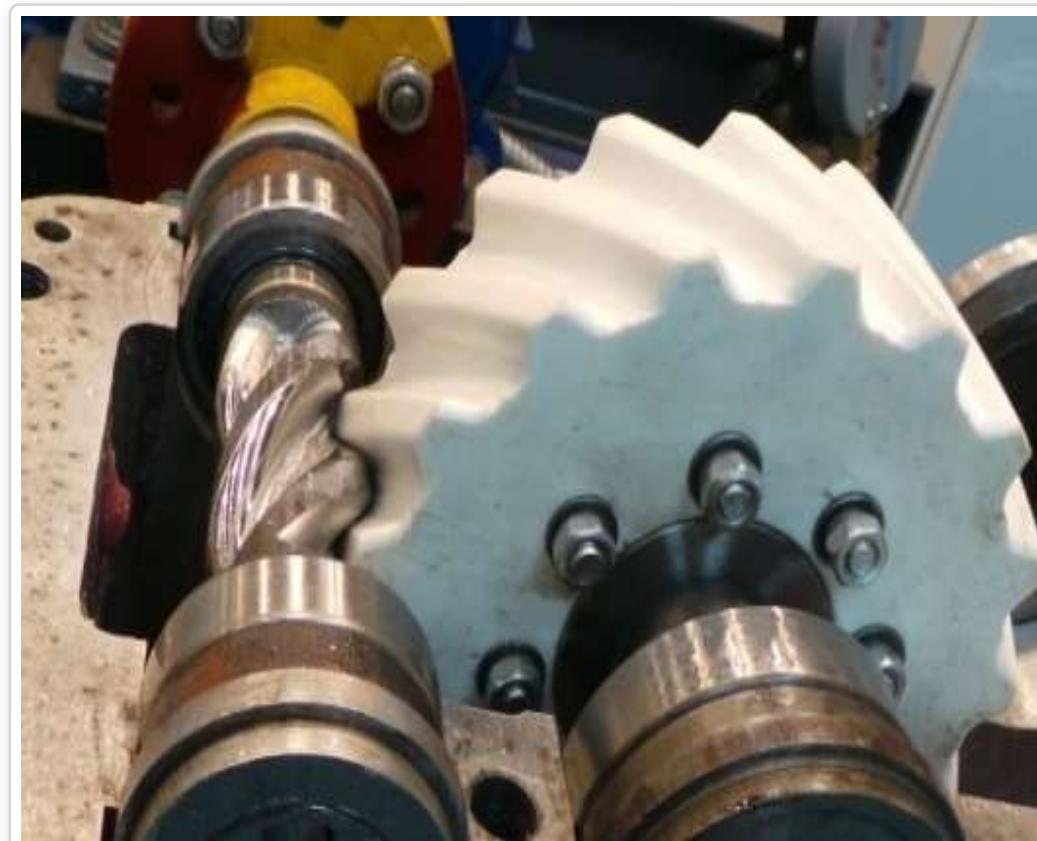
Стендовые испытания в Германии пластикового ЭЦ-колеса в паре с алюминием
