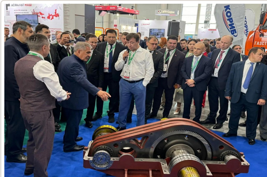
ЭЦ-редукторы станка-качалки: серийный и планетарные исполнения
